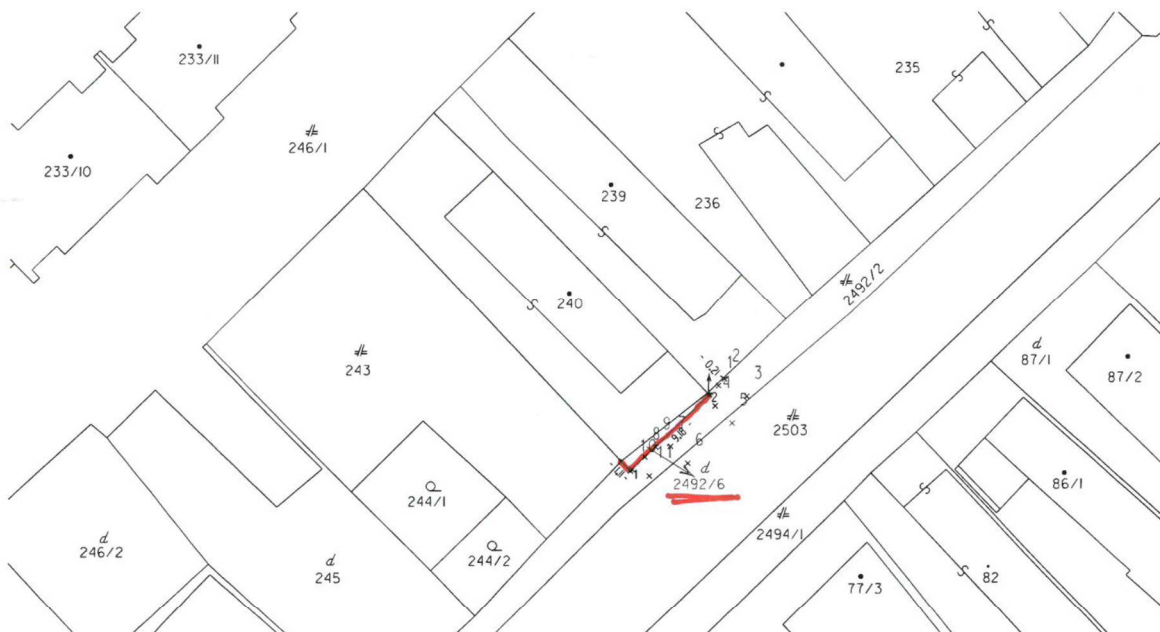
Geometrický plán je základom na právne úkony, keď údaje doterajšieho stavu výkazu výmer sú zhodné s údajmi platných výpisov z katastra nehnuteľností
